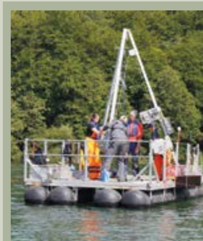
Abb. 2: Die Bohrplattform schwimmt auf dem Holzmaar und die Wissenschaftler:innen sind bereit, Sedimentkerne aus einer Wassertiefe von 20 m zu bergen. © Foto: GEOPOLAR, Institut für Geographie, Universität Bremen
